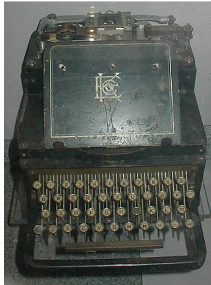
Abbildung H.9: Kleinschmidt-Perforator , gebaut um die 1920er Jahre: Mit diesem einer Schreibmaschine ähnelndem Gerät stanzte man in der kommerziellen Nachrichtenübermittlung Morsezeichen in Papier-Lochstreifen. Das Blatt mit der Text-Vorlage wurde auf der Metallplatte (in der Mitte) abgelegt. Mit dem fertigen Lochstreifen wurde der automatische Sender gesteuert, der auf diese Weise eine extrem schnelle Übertragung mit bis zu 300 Worten pro Minute erreichte. Dies waren die Vorgänger der späteren Fernschreib-Technik. [ http://www.officemuseum.com/ImagesWWW/Edward_Kleinschmidt_printing_telegraph_punched_code_on_tape_NMAH_Smithsonian_OM.jpg ]
